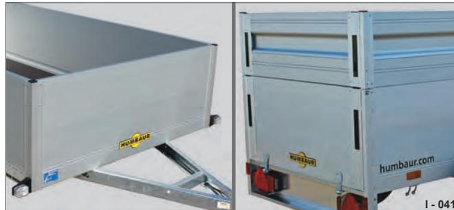
**Abb. 51** Bordwand 500 mm / BW-Aufsatz 350 mm
