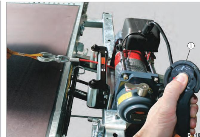
Abb. 45 Beispiel 2: Seilwinde mit Fernbedienung
