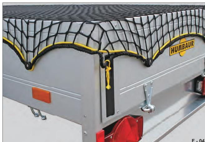
Abb. 105 Abdecknetz gespannt
