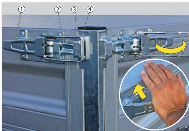
Abb. 6 Spann-Verschluss (HU, HUK, HT, HTK)
