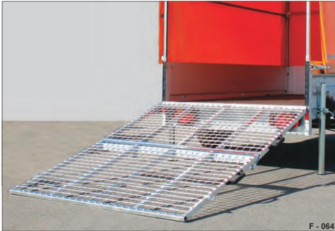
Abb. 67 Beispiel 1: Stahlgitter-Überfahrwand
