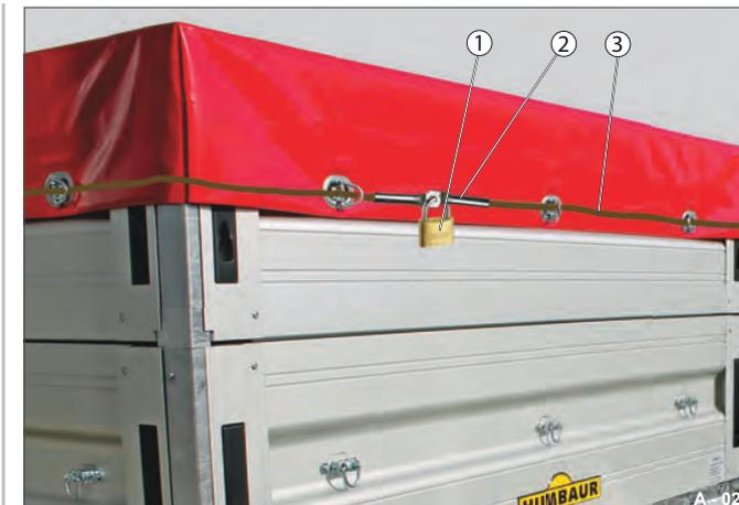
Abb. 60 Zollseilsicherung als Diebstahlschutz
