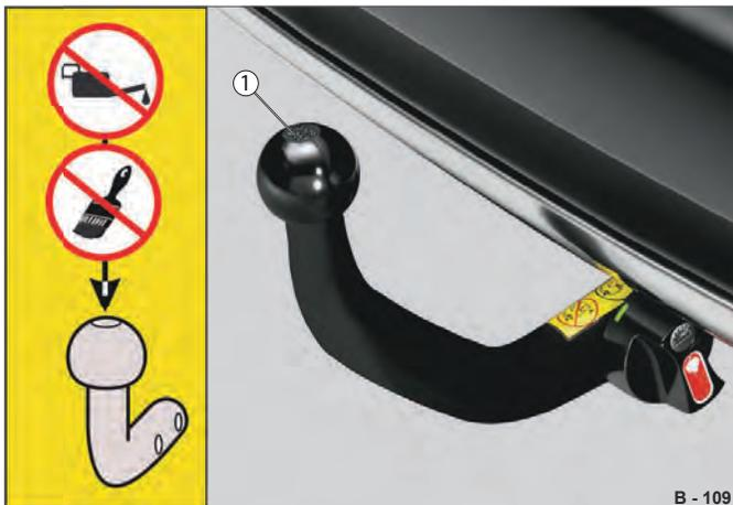
Abb. 14 Voraussetzung für Sicherheitskupplung
