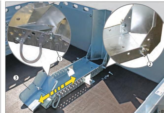
Abb. 100 Motorradständer aufgeklappt / gesichert
