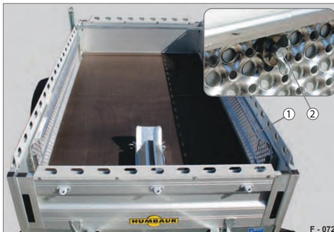
**Abb. 75** Beispiel: HA-Allrounder, Auffahrschienen gesichert
