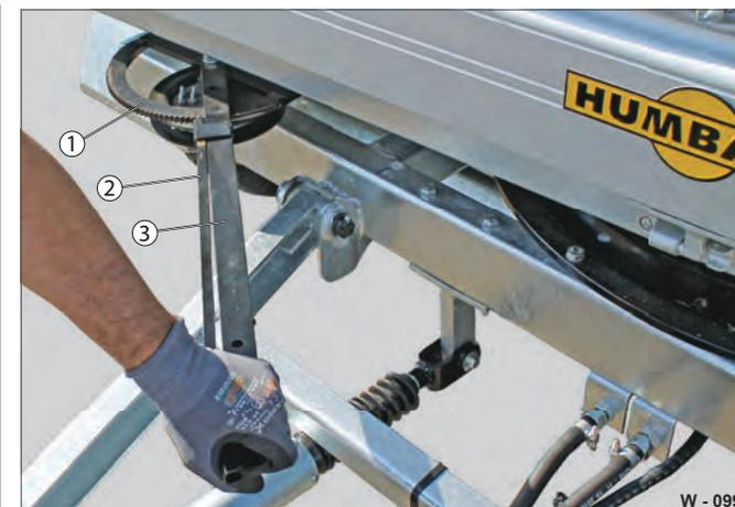
Abb. 57 Drehkranz-Bremse Schmierstelle
