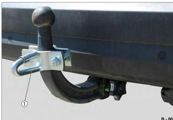
**Abb. 5** Beispiel: Klemmvorrichtung an der Kupplung
