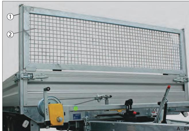
Abb. 29 Stahlgitter-Aufsatz
