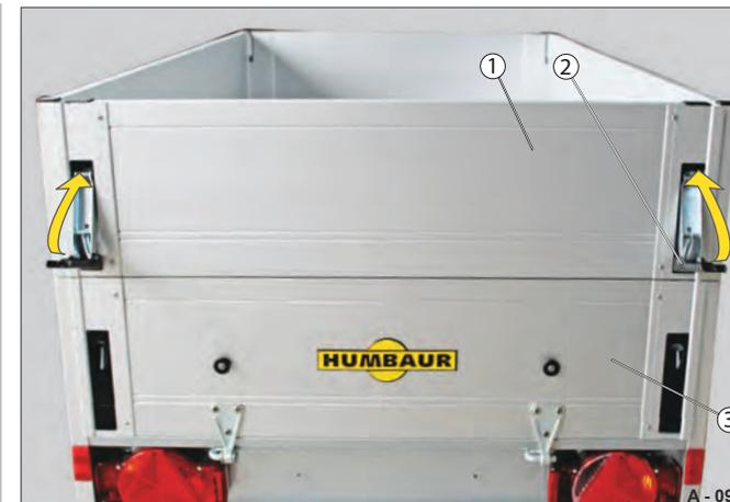
**Abb. 27** Hinteren / Vorderen Bordwandaufsatz montieren
