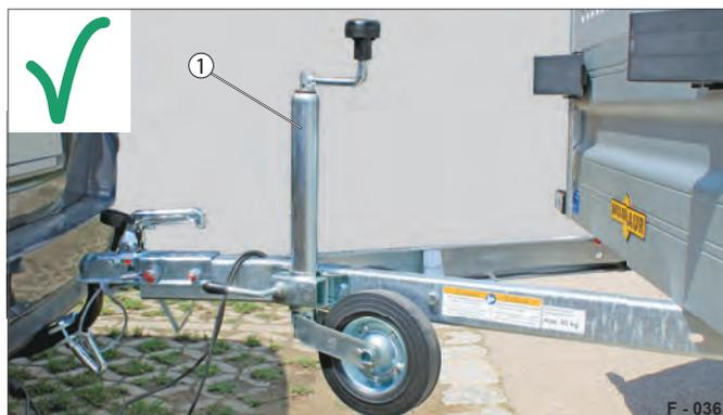
Abb. 6 Stützrad (in Fahrstellung) richtig
