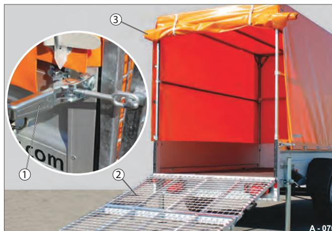
Abb. 82 Hochplane geöffnet, Überfahrwand abgeklappt
