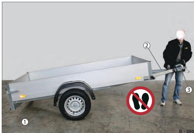
Abb. 71 Rangieren mit ungebremstem Anhänger
