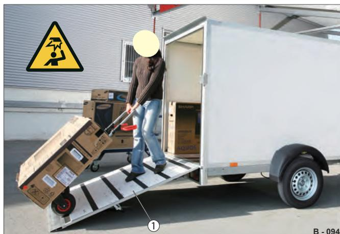
Abb. 34 Überfahrwand bedienen
