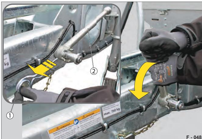
Abb. 46 Feststellknebel lösen
