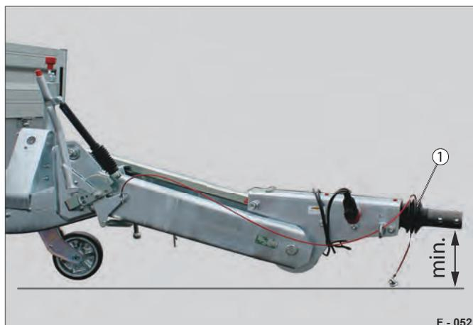
**Abb. 49** HV-Deichsel minimal Höhe
