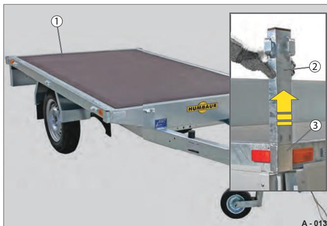
**Abb. 14** Bordwände demontiert, Eckrunge ausgesteckt
