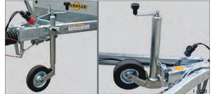
Abb. 36 Stützrad / Automatik-Stützrad
