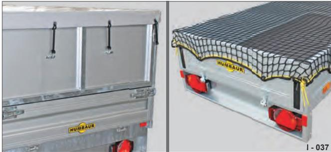
**Abb. 47** Flachplane auf Aufbauten / Abdecknetz
