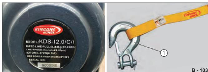
Abb. 42 Beispiel: Hersteller-Typenschild
