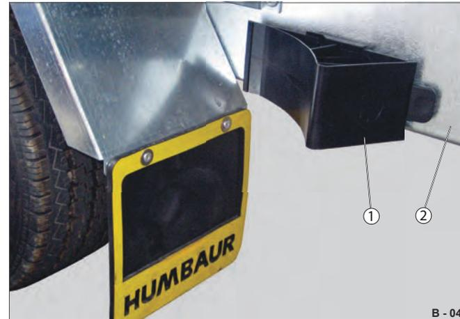
**Abb. 77** Beispiel 2: Unterlegkeile waagrecht seitlich
