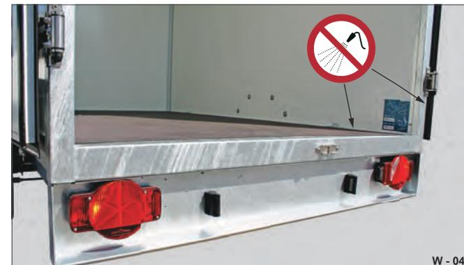
Abb. 83 Innenraum reinigen
