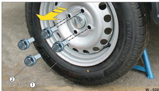
**Abb. 30** Defektes Rad abziehen
