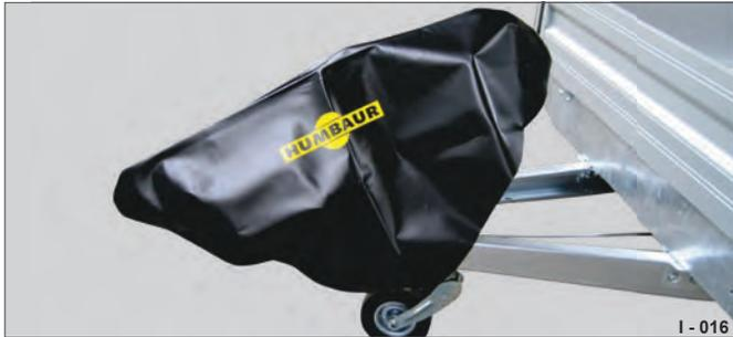
Abb. 30 Abdeckung der Kupplung / Auflaufeinrichtung
