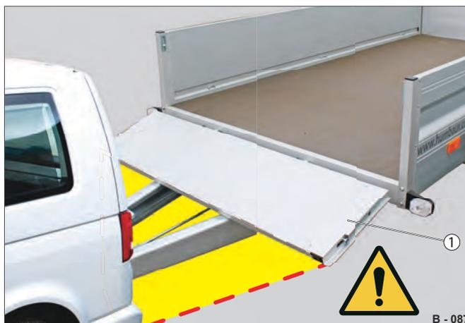
**Abb. 24** Fahren mit geöffneter Stirnbordwand
