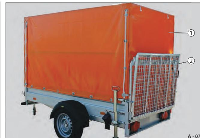
Abb. 83 Hochplane geschlossen (Fahrstellung)
