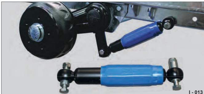
Abb. 31 RSD lose oder werkseitig eingebaut
