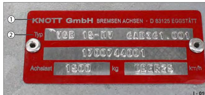
Abb. 24 Beispiel: Typenschild Knott-Achse, ungebremst
