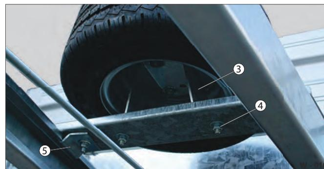
Abb. 18 Befestigung des Ersatzrades
