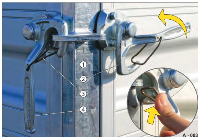
**Abb. 8** Winkelhebel-Verschluss (HTK, HT, Koffer, Pferd)
