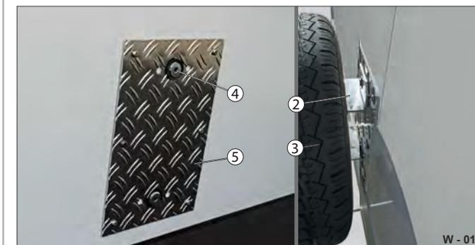
Abb. 20 Befestigung des Ersatzrades
