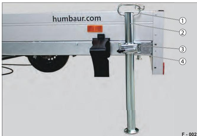
Abb. 25 Schiebestützen (Stützstellung)
