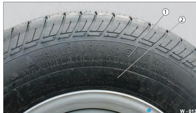
Abb. 15 Reifenfülldruck - Angaben
