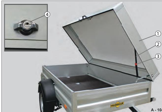
Abb. 93 Deckel seitlich befestigt
