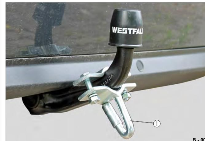
**Abb. 7** Beispiel: Klemmvorrichtung an der Kupplung
