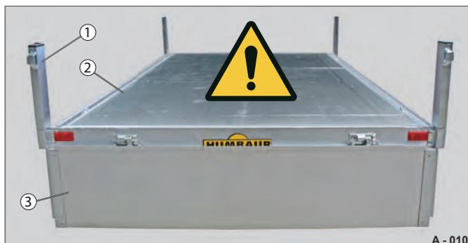
Abb. 2 Ungesicherte Bordwände / Eckrunge
