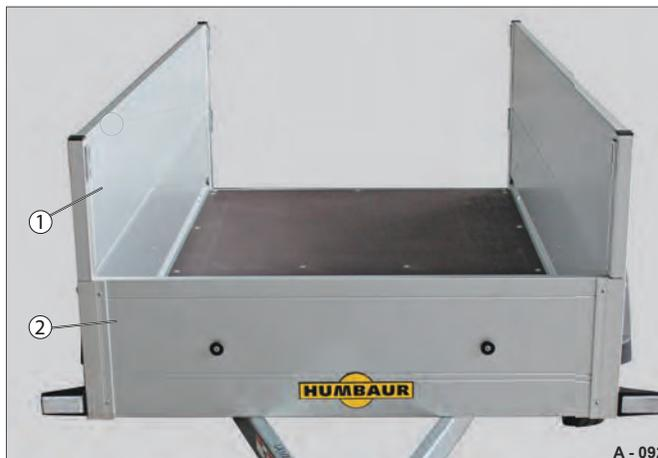
**Abb. 26** Heckbordwand / Bordwandaufsatz demontiert
