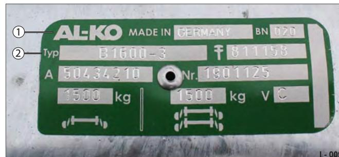
Abb. 25 Beispiel: Typenschild AL-KO-Achse, gebremst
