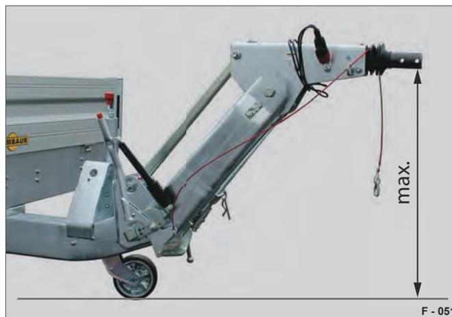
**Abb. 50** HV-Deichsel maximal Höhe
