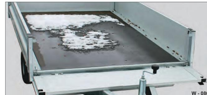
Abb. 89 Holz-Ladefläche / Mehrschichtholzplatte
