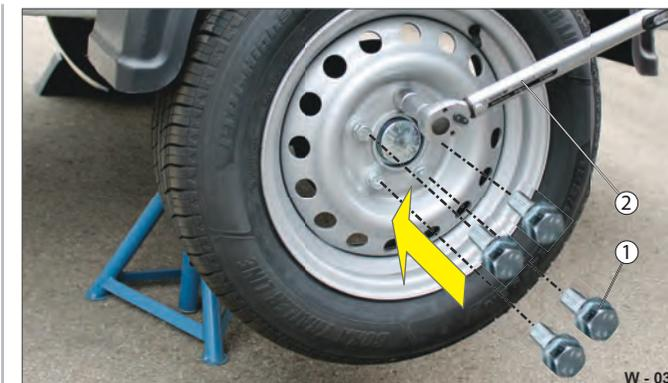
**Abb. 32** Ersatzrad montieren
