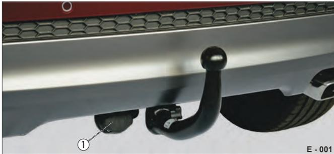
**Abb. 1** Elektrische Verbindung am Zugfahrzeug (PKW)
