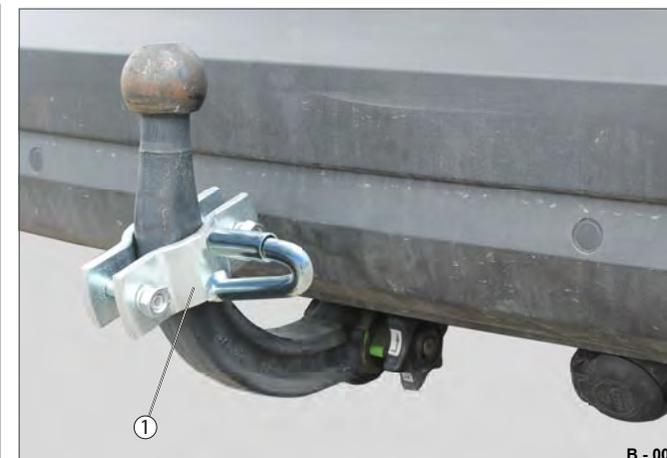
**Abb. 6** Beispiel: Klemmvorrichtung an der Kupplung
