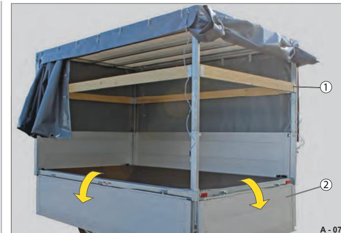
Abb. 86 Bordwände abgeklappt
