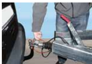
Bild: Kugelkupplung positionieren
