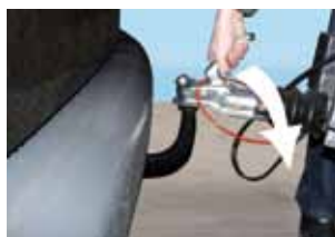
Bild: Kugelkupplung schließen
