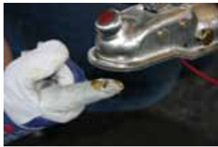
Bild: Kugelschale fetten
