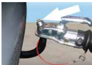
Bild: Kontrollanzeige an der Kugelkupplung
