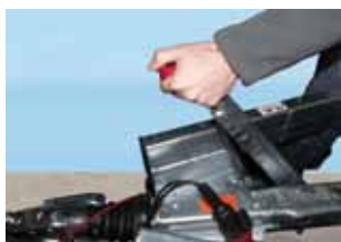
Bild: Feststellbremse lösen
