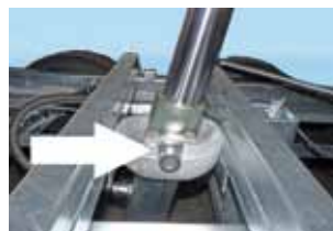
Bild: Kardanring schmieren
